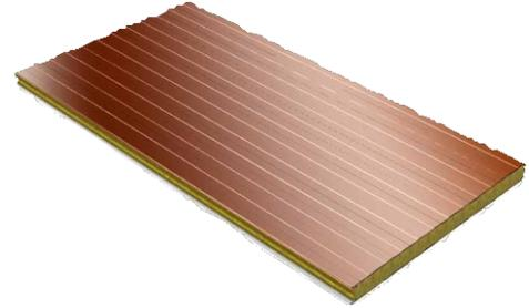
**Wärmedämmendes Wandpaneel „POLAR“ mit sichtbarer Befestigung mit Seiten (oben und unten) aus verzinktem Stahlblech mit galvanischem Schutz (PES, PVDF.) mit Kern aus Mineralwolle mit einer Dicke von 100 mm.**
